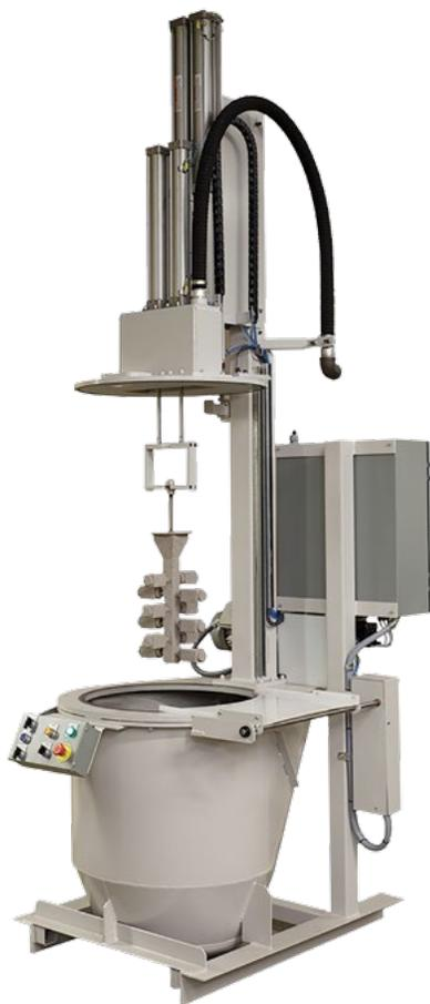
Вакуумный бак для суспензии
