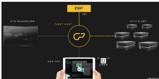
Центральная система управления робота Otto использует карту производственных помещений для определения наиболее оптимального пути движения. Если робокар встречает на своем пути препятствие, он «видит» его и автоматически находит новый путь для достижения своей конечной точки маршрута. Робот Otto обладает высокой надежностью, его активная система подвески позволяет ему адаптироваться к неровностям поверхности и даже преодолевать небольшие препятствия (до 22 мм в высоту).
