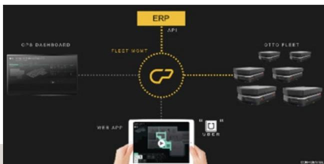
奥托机械手的中央管理系统使用工厂地图来决定奥托的最好路径。如果奥托遇到障碍物，他们将“看到”他们，并自动找到到达目标的新路径。奥托机械手很坚固，其主动式悬挂减震系统使它可以适应状态不佳的地面，甚至越过小障碍物（高达22毫米）。
