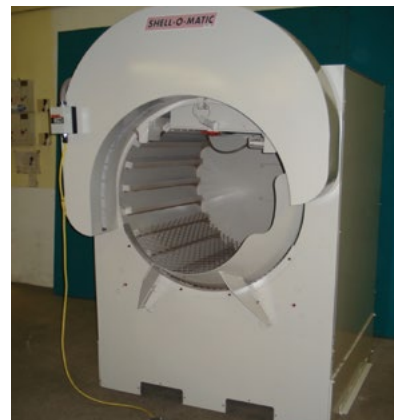
Барабанный пескосып с ручным управлением
