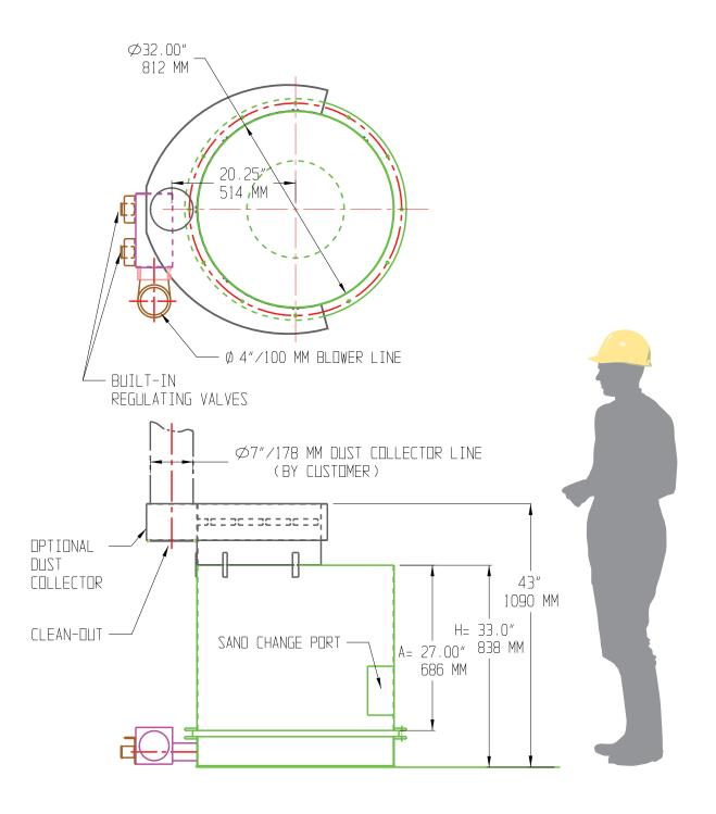
AUTOMATIC HOPPER FEEDER FOR SAND WITH LEVEL CONTROL SYSTEM
