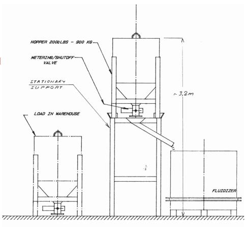
PNEUMATIC HOPPER FEEDER FOR SAND WITH LEVEL CONTROL SYSTEM
